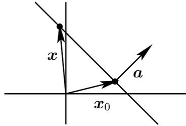
平面内の直線を  $L$  とする。  $L$  上に 1 点を取り、その位置ベクトルを  $x_0 = (x_0, y_0)$  とする。  $L$  と直交するベクトル (法線ベクトル) を  $a = (a, b)$  とする。  $L$  上の任意の点に対しその位置ベクトルを  $x = (x, y)$  とすると、ベクトル  $x - x_0$  とベクトル  $a$  は直交しているので内積は 0 である。
