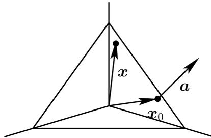
空間内の平面を  $L$  とする。  $L$  上に 1 点を取り、その位置ベクトルを  $x_0 = (x_0, y_0, z_0)$  とする。  $L$  と直交するベクトル (法線ベクトル) を  $a = (a, b, c)$  とする。  $L$  上の任意の点に対しその位置ベクトルを  $x = (x, y, z)$  とすると、ベクトル  $x - x_0$  とベクトル  $a$  は直交しているので内積は 0 である。
